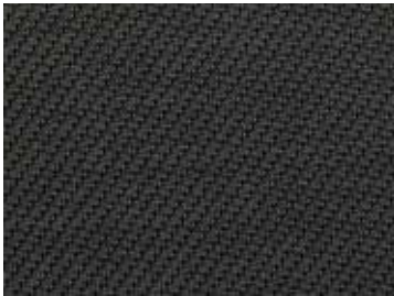
Glasfasergewebe Gewebe aus PVC-ummantelten Glasfasergarnen, Webart Sergé
