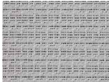
Polyestergewebe Gewebe aus hochfesten Polyestergarnen, vorgereckt und PVC-fixiert
